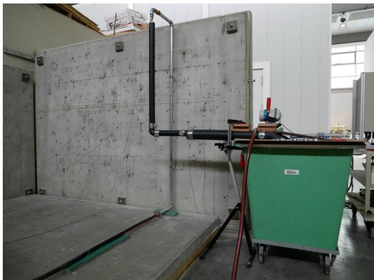
Abbildung 34: An einer Empfangsplatte montierte Trinkwasserleitung
