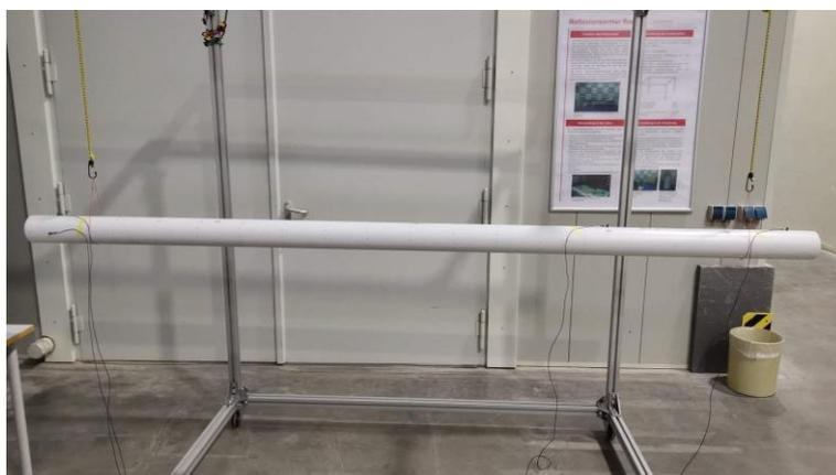
Abbildung 35: Frei aufgehängtes Abwasserrohr mit montierten Beschleunigungsaufnehmern
